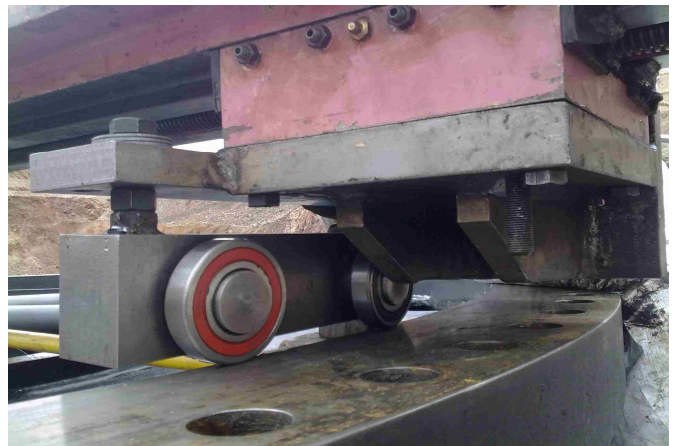
Fuente: 13032010875.JPG Detalle patín (Soporte auxiliar)
